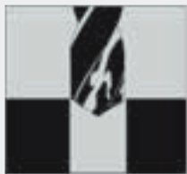
Высверливание поврежденной резьбы
