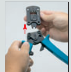
Zange drehen und Bolzen bis Anschlag herausziehen
