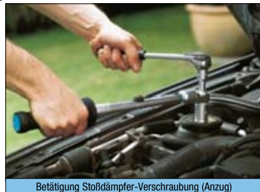
Betätigung Stoßdämpfer-Verschraubung (Anzug)
